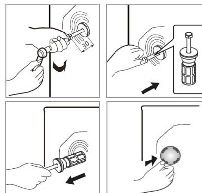
Entfernen Sie die Transportbolzen mit einem Schraubenschlüssel. Setzen Sie die beiliegenden Abdeckkappen ein.
